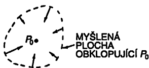
Obr. 5.1 Kdyby bod P_0 představoval polohu stabilní rovnováhy kladného náboje, směřovalo by elektrické pole všude v okolí k P_0 .
