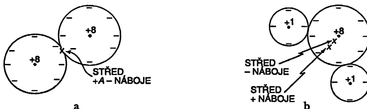
Obr. 11.1 a) Molekula kyslíku s nulovým dipólovým momentem. b) Molekula vody má permanentní dipólový moment p_0 .
